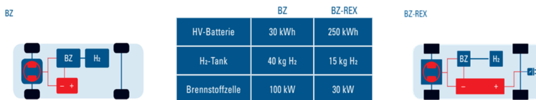
Abbildung 5: Funktionsweise von BZ-Hybrid und BZ-REX Fahrzeugen (NOW GmbH)
