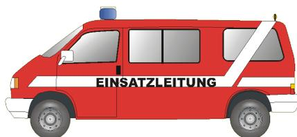
Fahrzeuge der Einsatzleitung, die insbesondere mit Informations- und Kommunikationsmitteln (Alarm- und Einsatzpläne, Gefahrstoff-Nachschlagewerke, Telefon, erweiterbare Funkausrüstung, ggf. Fax, PC mit Datenbanken) ausgerüstet sind. Typen der ELW werden nach Norm in Abhängigkeit von der Größe gekennzeichnet mit ELW 1 (Kleinbus, Transporter) bzw. ELW 2 (Lkw oder Abrollbehälter).
