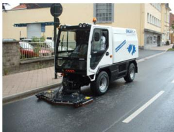
Fahrzeug zur Beseitigung von Öls Spuren auf Fahrbahnoberflächen. Es wird mit speziellen Rotordüsen ein Wassergemisch unter Hochdruck auf die zu reinigende Fläche aufgebracht. Im gleichen Arbeitsgang wird durch ein Zweikammer-Vakuumsystem der abgelöste Schmutz mit dem Wasser abgesaugt. Auch Wände und
